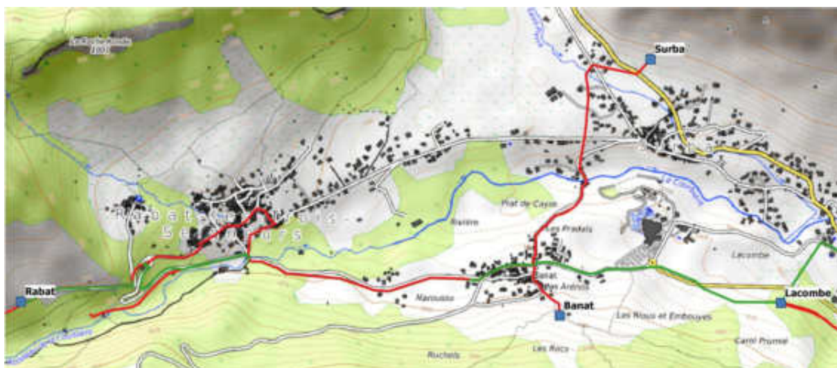
Figure 5 – Localisation des conduites d'adduction en aval du réservoir de Rabat
